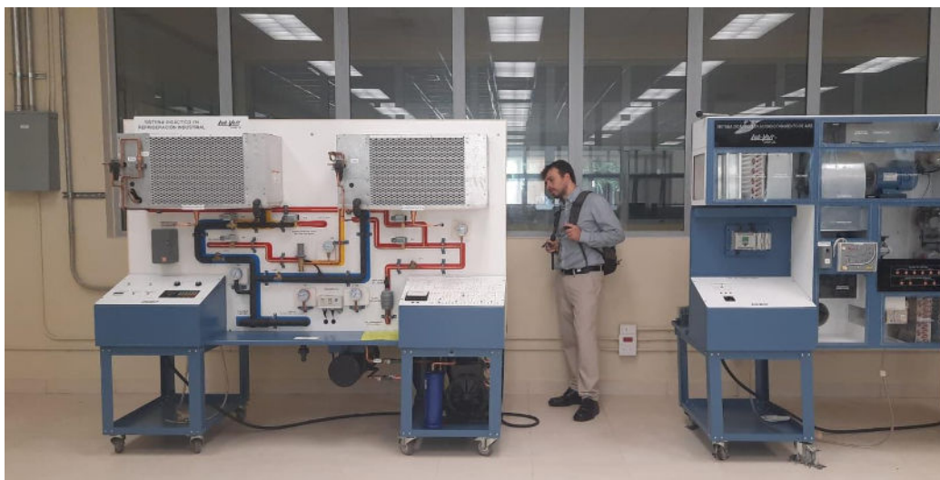
Figura 4 Bancos de prueba para circuitos de refrigeración enfocados en la educación en la UASD (fuente: foto realizada durante la visita técnica)
