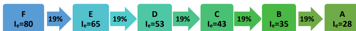
Figura 5 Redução de consumo necessária para que um modelo consiga atingir de uma classe de eficiência à seguinte na etiqueta Europeia e a etiqueta E.1 proposta para os Refrigeradores de Bebidas no Brasil
