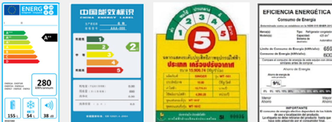
Figura 6. Ejemplos de diseños de etiquetas. El europeo usa una clasificación de A a G, el chino usa del 1 al 5; mientras que Tailandia va del 5 al 1 y México maneja porcentajes.
