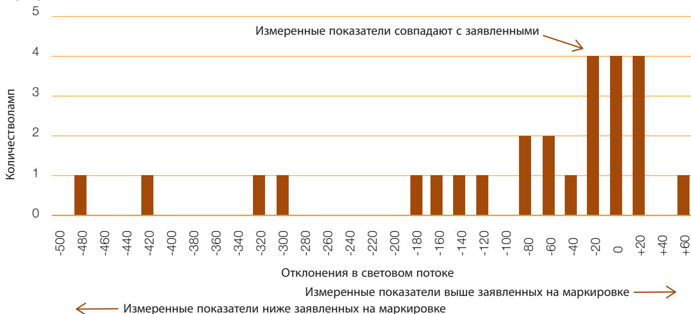
Рисунок 4: Результаты тестирования светового потока, сравнение измеренных показателей с заявленными на маркировке
